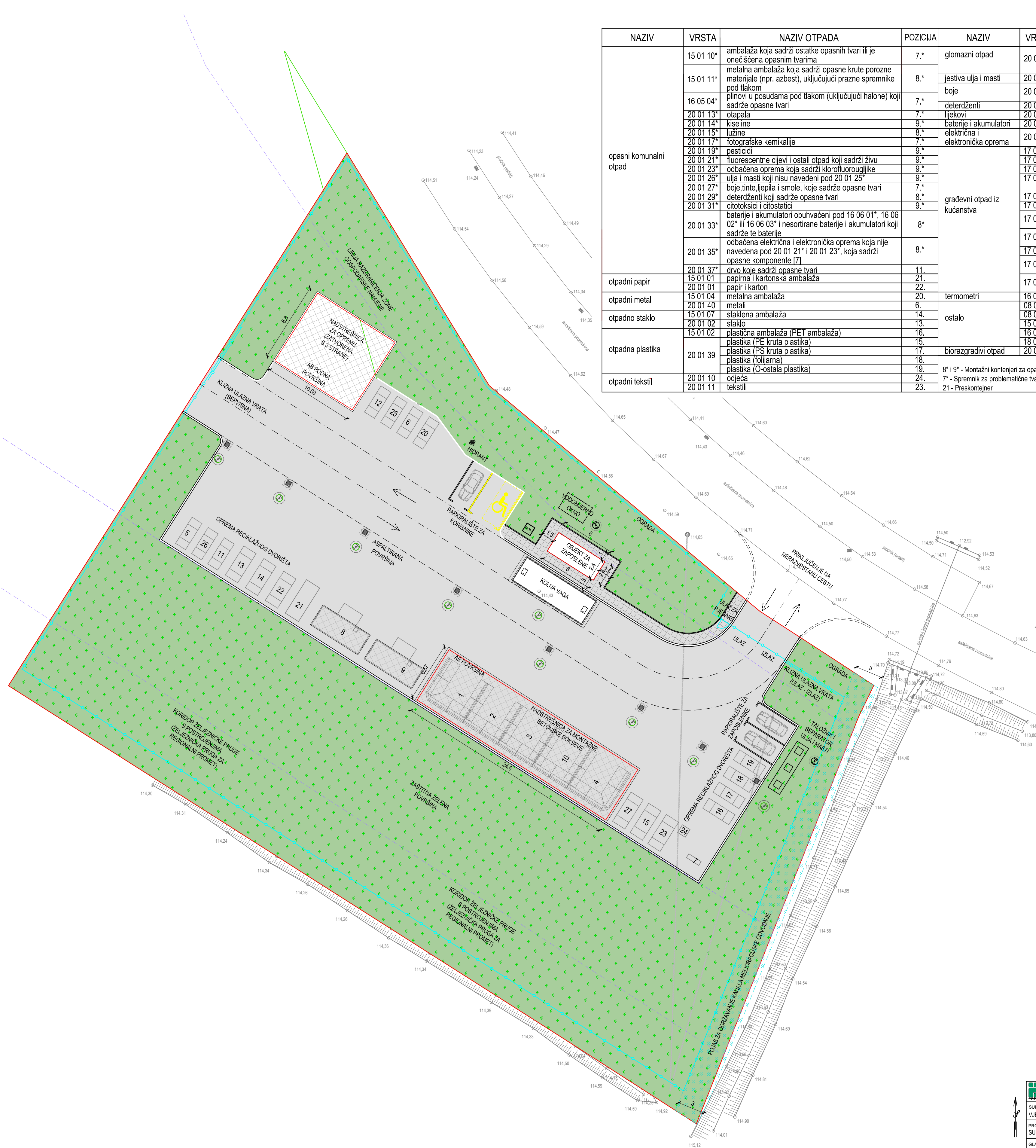
TEHNOLOŠKA DISPOZICIJA OBJEKATA I OPREME RECIKLAŽNOG DVORIŠTA M 1:250
