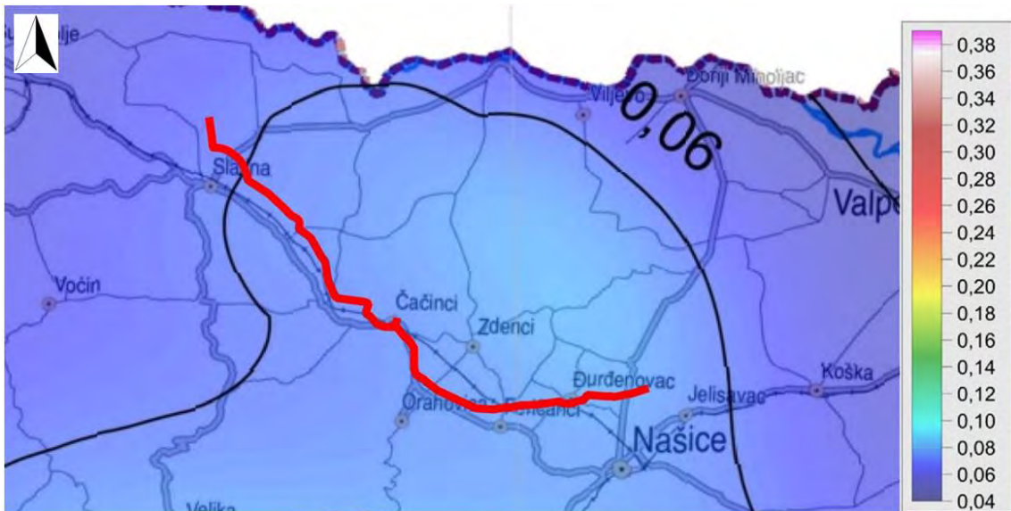
Slika 3.3-2: Isječak iz karte potresnih područja Republike Hrvatske za povratno razdoblje od 95 godina (Izvor: PMF, Geofizički odsjek, Marijan Herak, Zagreb, 2012.)
