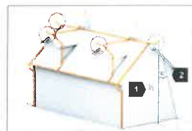
1 ( h ) = visina građevine, 2 = zaštitni kut \alpha
